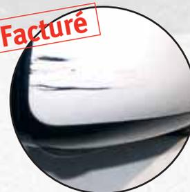
Rayures et éraflures excédant une long. max. de 50 mm avec altération de la peinture en cas de rétroviseurs peints. En cas de rétroviseurs non peints, les éraflures altérant la matière de base.
