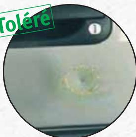
Le nombre de bosses ou d'impacts ne doit pas excéder 2 par élément de la carrosserie du véhicule, par exemple la porte ou le bas de porte.
