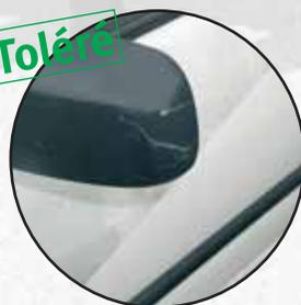
Rayures ou éraflures d'une long. max. de 50 mm sans altération de la peinture dans le cas de rétroviseurs peints. Si ces derniers ne le sont pas, les éraflures ne doivent pas atteindre la matière de base. La fonctionnalité ne doit pas être altérée.
